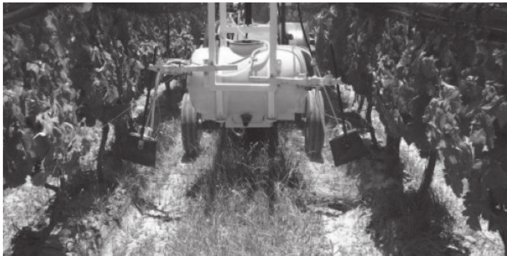
Figura 11: Prototipo para el control térmico de malezas en viñedos. INTA Mendoza
