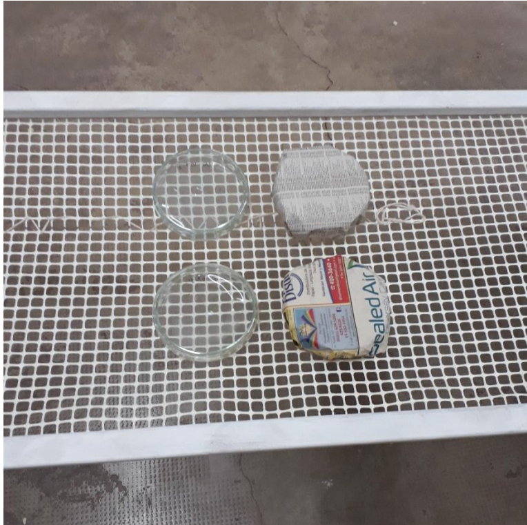
Ilustración 10: Grupo representativo de la manera que se colocaban las muestras antes de ingresar al equipo de UV-C. Muestras testigo e irradiada, por duplicado.
