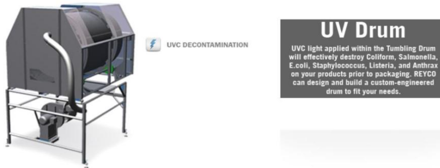
Ilustración 3: Tambor rotatorio con 32 lámparas UV-C para uso alimentario (Reyco Systems 2016)
