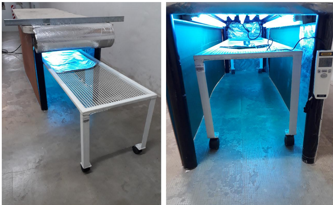
Ilustración 15: Interior del equipo en donde se observa las 7 lámparas adyacentes en la parte superior y la superficie de apoyo.
