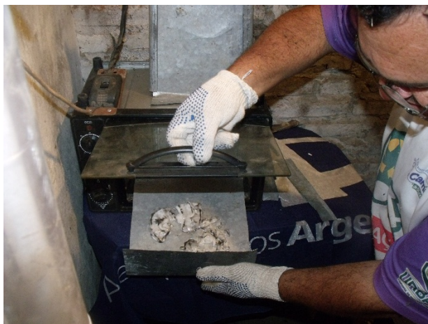
Figura 6: El “hornito” empleado para experimentar sobre el tratamiento térmico del EPS (Foto: Sebastián Careno)
