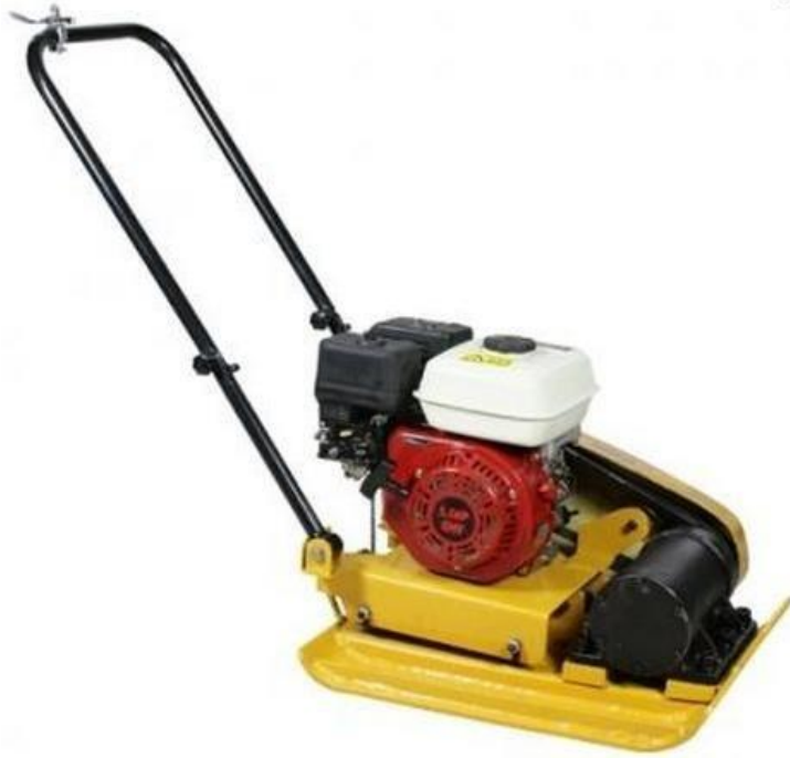
Fig. X: Compactadora como la que será usada
