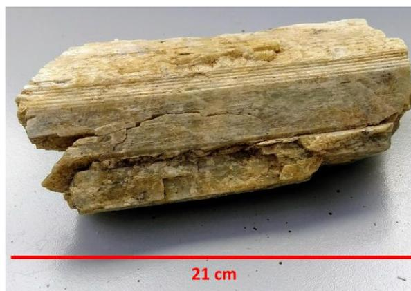
Figura 3.1. Imagen del mineral  $\alpha$ -espodumeno utilizado
