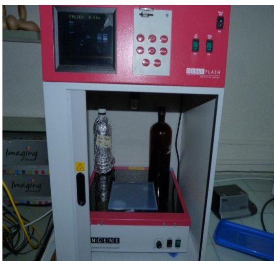
Figura 25: Transiluminador en el momento de colocación del gel para ser fotografiado Laboratorio de Botánica Este – Facultad de Cs. Agrarias - UNC
