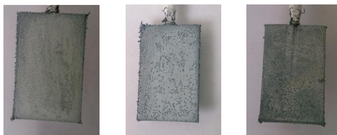
Figura 2: Fotografías de depósitos de zinc en cátodo para soluciones de 32,5, 65 y 130 g ZnCl 2 L -1 , respectivamente. Los depósitos metálicos pueden desprenderse fácilmente de la superficie del electrodo
