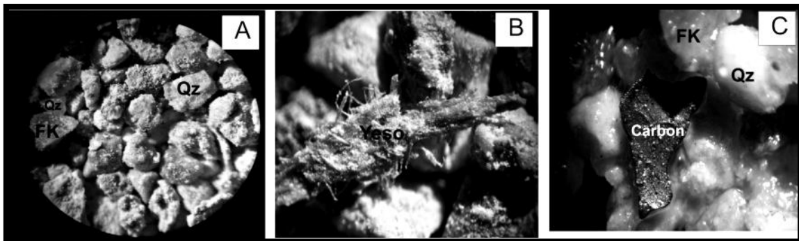
Figura 2: Fotografías A, B y C, corresponden a la clase [+30 -100] donde pudo reconocerse: fragmentos de cuarzo (Qz), feldespato potásico (FK), yeso ( CaSO_4 ), y un fragmento de carbón mineral.
