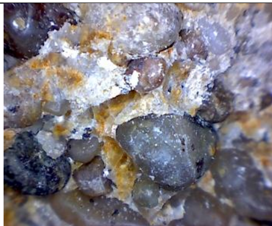
Fotografía 4: Aspecto al microscopio de la muestra 1, cementada por carbonatos.
