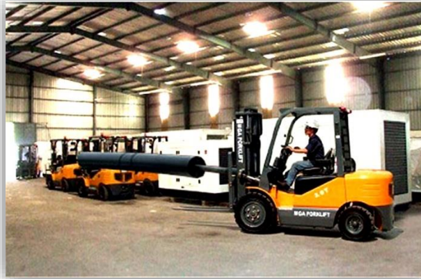
Fig. N°6.6: "Manipulación de rollos mediante lanza". Fuente: "Manual Técnico Geomembranas POLITEX".
